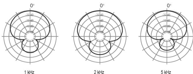
La curva di risposta in frequenza mostrata sopra (tolleranza di misura a +3dB) e il diagramma polare corrispondono alle specifiche tipiche della produzione di questo microfono.
