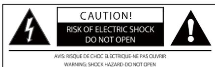
Il simbolo del fulmine con la punta a freccia all'interno di un triangolo equilatero avverte l'utente della presenza di una "tensione pericolosa" non isolata all'interno del prodotto, che può essere di entità sufficiente a costituire un rischio di scossa elettrica.
